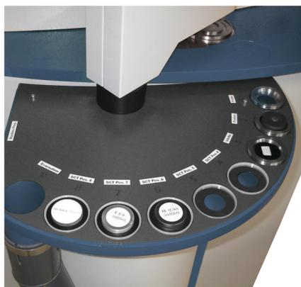
ARL OPTIM'X 光谱仪的环形载样器
